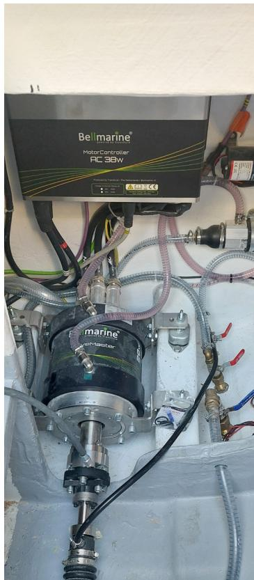
L'échange d'un moteur thermique pour un moteur électrique existe déjà depuis de nombreuses années dans le secteur du nautisme. En effet, lors de la construction, la motorisation d'un navire est indépendante. Les navires peuvent être remotorisés, après un signalement auprès de la direction départementale des territoires et de la mer.
